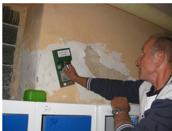
Obr. 12: Měření rozsahu vlhkosti ve zdivu pomocí impedančního vlhkoměru
